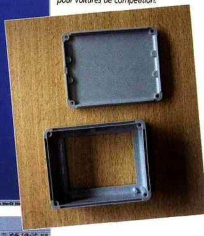
Vue 3D d'un moule réalisé avec TopSolid'Mold de Missler Software (doc. Micro érosion). En médaillon, les éléments moulés d'un boîtier de chronométrage pour voitures de compétition.
